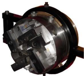
**Macchina speciale CNC** per la realizzazione di maschiature senza rotazione del pezzo da produrre.
