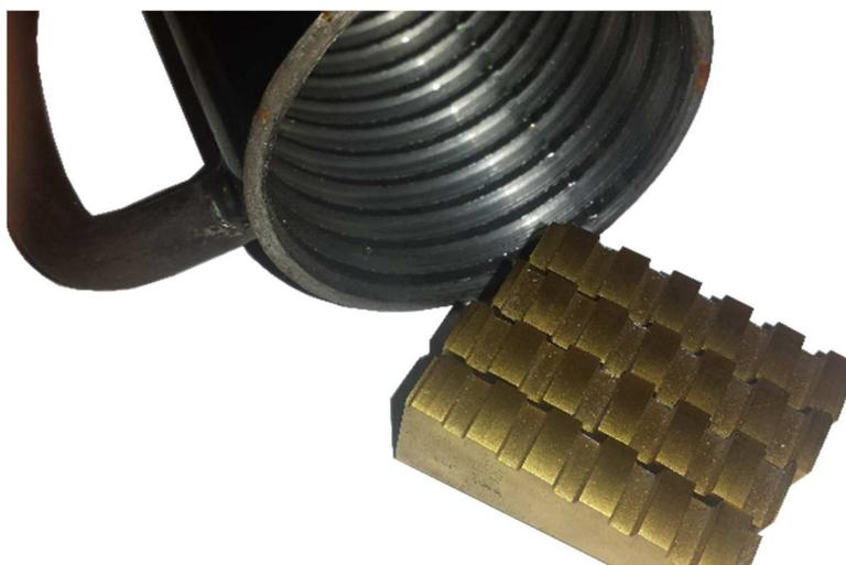
Speciale testa per maschiatura che consente il rapido rientro dell'utensile alla fine dell'operazione di filettatura, senza inversione della rotazione.
