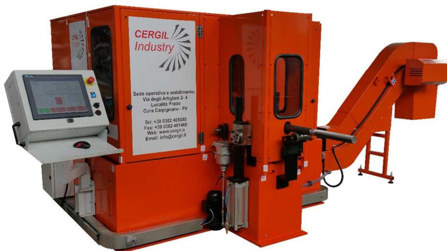
**Macchina di produzione** a comando numerico per la realizzazione di filettature tramite taglio o deformazione, senza rotazione dei pezzi da lavorare.
